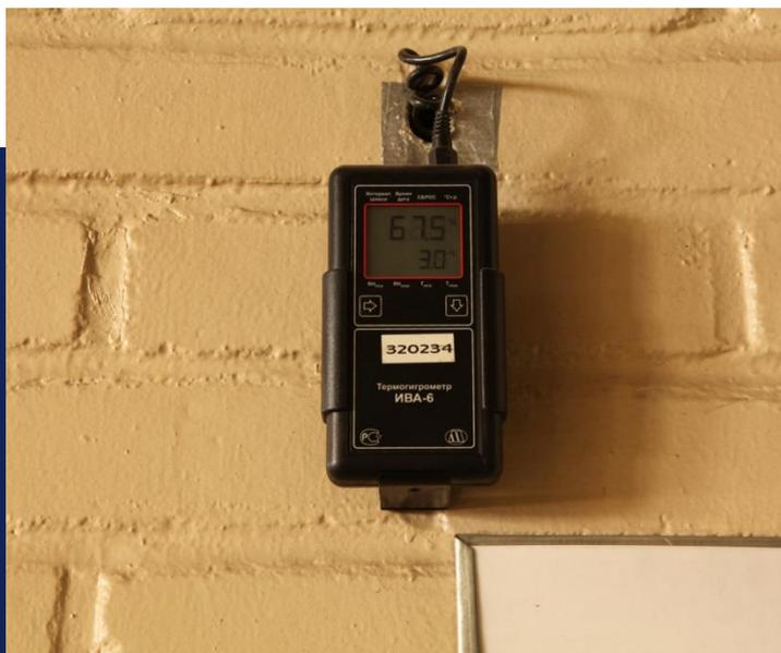
Показания датчиков со всех зон централизованно управляются и контролируются системой, а также показываются на термогигрометре, установленном в зоне хранения.
