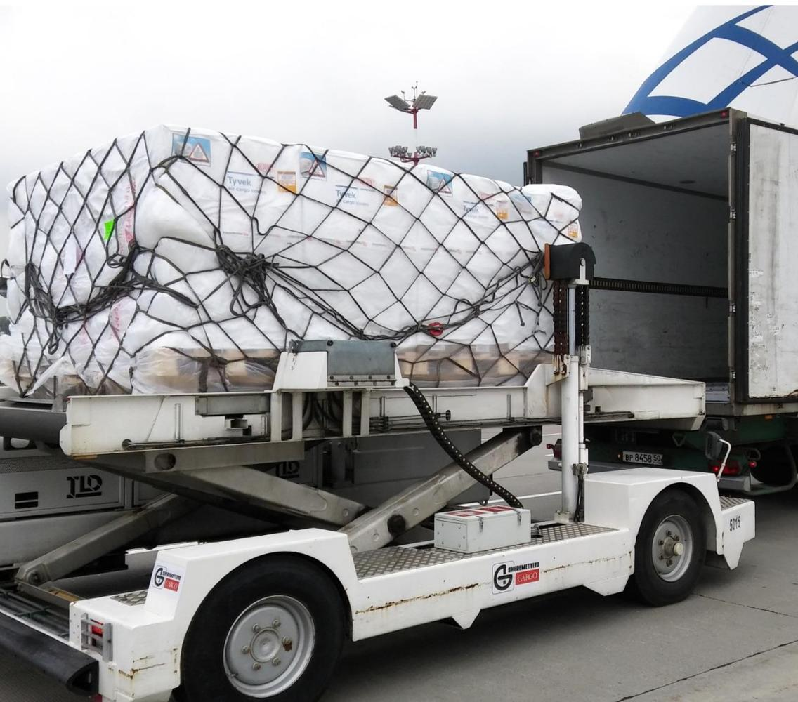
Для доставки температурных грузов по перрону используются средства перронной механизации и автомобили с термоустановкой, а также термотележки и термочехлы.
